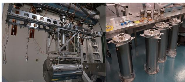
図 21 Top Assembly (左) と分離された空洞 (右)
