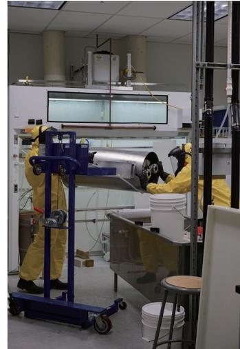
図 12 空洞内外の水洗工程
