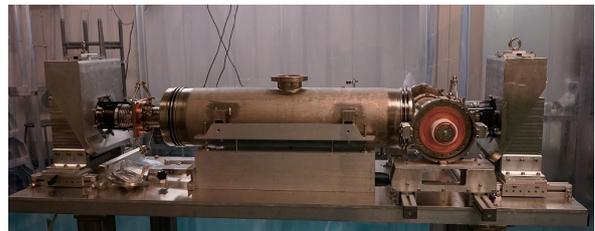
図 6 ゲートバルブ、入力カップラーが設置された ARIEL#3
