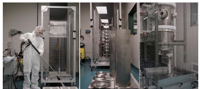
図 14 部品洗浄 (左, 中) と空洞洗浄 (右)
