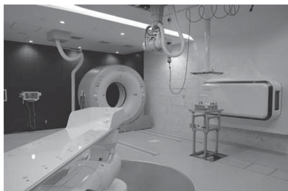
図9 治療室内でのコミッショニング風景：右手にある照射ポート前には、位置決めシステムや照射システムでのコミッショニングで使用するQAファントムが設置されている。
