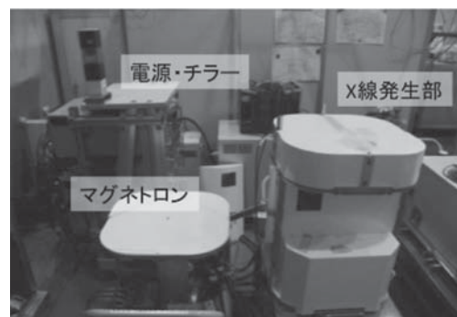
図 1 950 keV X 線システムの外観写真 5)
