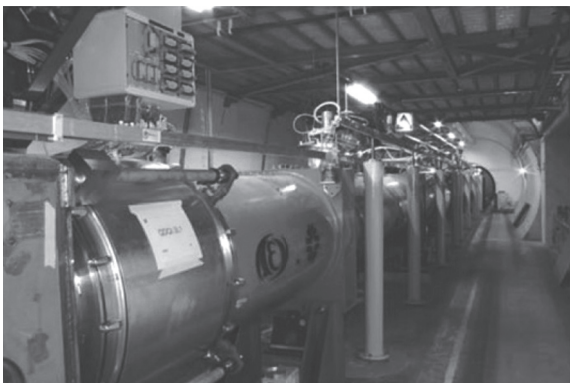
図 11 直線部のインナートリプレット。オレンジ色のクライオスタットの中の四重極超伝導マグネットがビームを衝突点で 30 \mu\text{m} のスポットに絞る。
