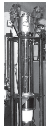
図 17 上図は SP-8 における 80 MW Klystron 28) 。下左図は 150 MW Klystron の電子銃。下右図は SLAC から CPI に技術移転された 150 MW Klystron (VKS-8333A) 29) 。
