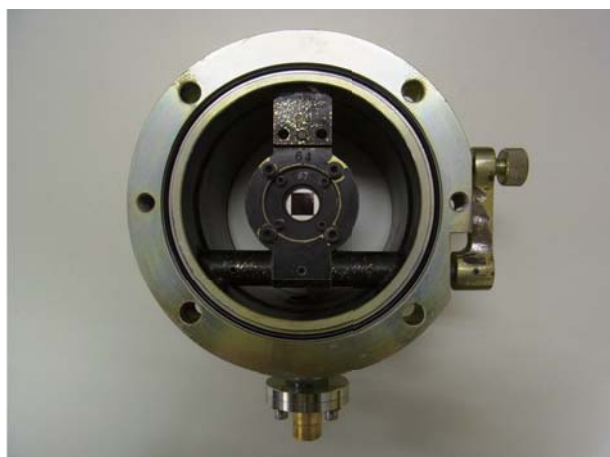
図3 光軸測定用の四分分割型シリコンフォトダイオード。QPDはサブホルダーの中心に装着される。右手に見えるレバー(蝶番)を手動で回転させるとサブホルダーが回転しQPDが直立(又は倒立)する。ホルダー内径: \phi 130 mm.
