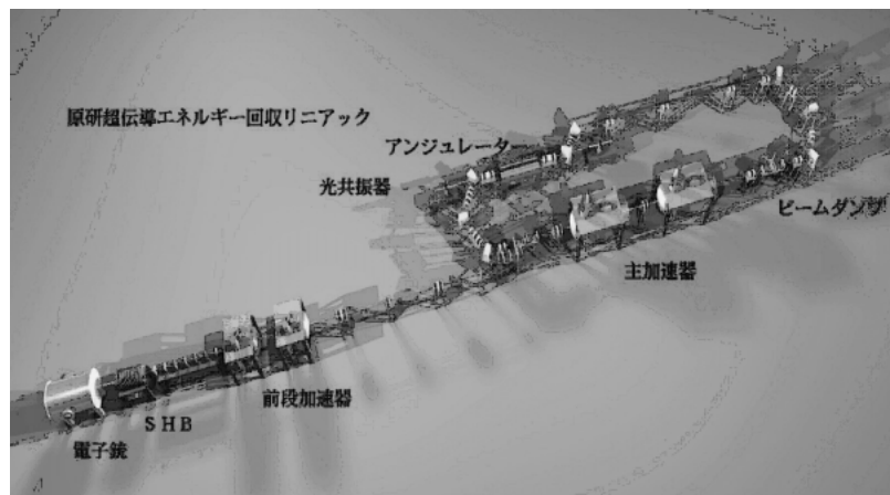
図1 原研フェムト秒 10 kW 超伝導エネルギー回収型リニアック自由電子レーザー
