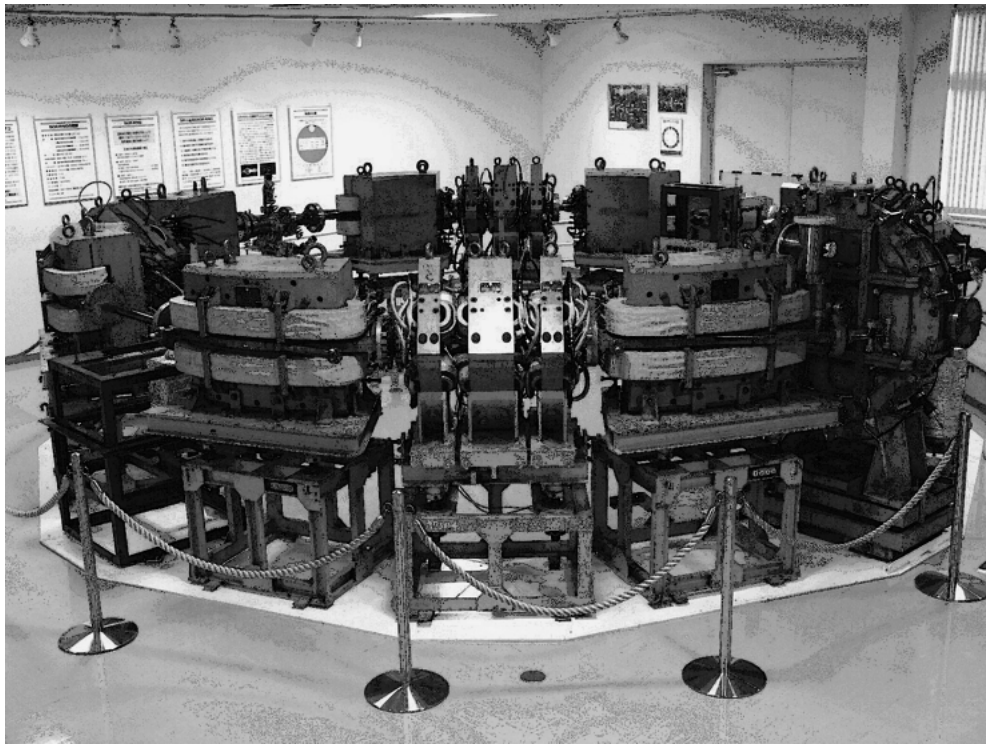
SPring-8 の見学者対応の広報施設「普及棟」展示室に再組立された SOR-RING。本邦初演の挿入光源の実験に用いられたアンジュレータが、RF 加速空洞の左に組み込まれている。
