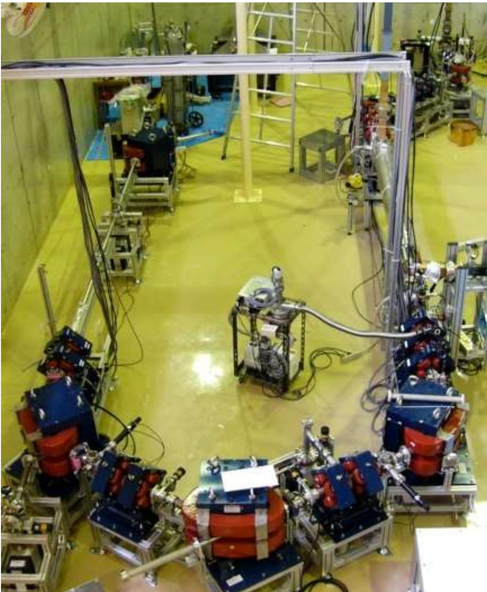
熱陰極高周波電子銃を電子源とした最大エネルギー40 MeVの電子線形加速器を用いた中赤外自由電子レーザー。
