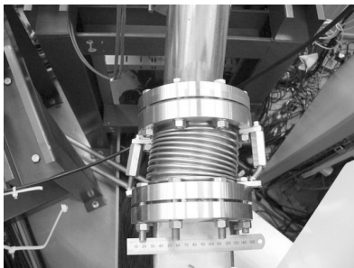
図 7：ブースターの振分電磁石チャンバの前後の押し潰されたベローズ
