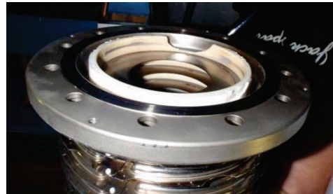
図5：リークを発生した ECR イオン源入射部の前段加速管。振動でセラミクスが破壊された
