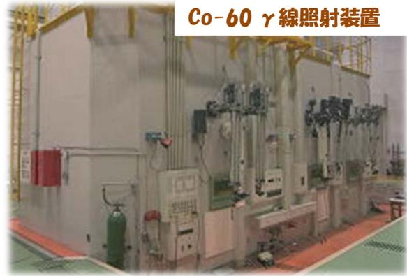
3本のコバルト60 $\gamma$ 線源( 7 TBq、76TBq、303 TBq )、照射実験用ホットケージ室(6 m<sup>2</sup>と10 m<sup>2</sup>)を用いて、各種材料に於ける放射線照射効果、放射線重合、放射線による材料破壊、生物組織に対する放射能影響などの研究に利用されています。
