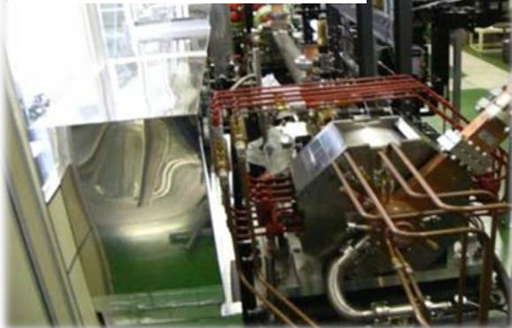
RF電子銃付Sバンドライナックは世界最高時間分解能を有する低エミッタンス、フェムト秒電子線発生装置です。フェムト秒時間領域における量子ビーム誘起超高速現象の解明やナノ空間内での反応制御に加え、放射線治療に関する研究も行っていきます。
