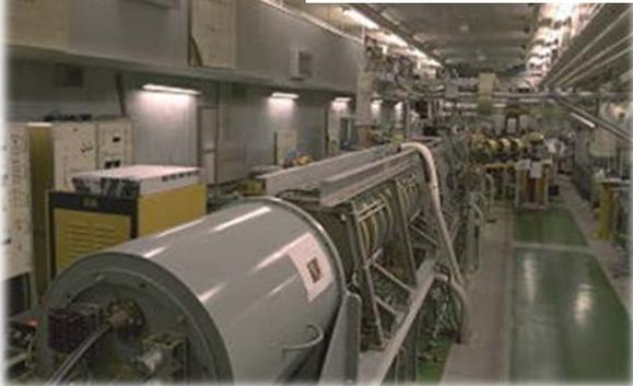
Lバンド電子ライナックは世界トップクラスの大強度単バンチ電子線ビーム発生装置です。この装置で発生する単バンチビームの電荷量では、世界最高の91ナノクーロンです。運転モードには3種類あり、ナノ秒からサブピコ秒の時間領域における各種反応素過程の解明や自由電子レーザー、パルス放射線計測の研究に利用されています。
