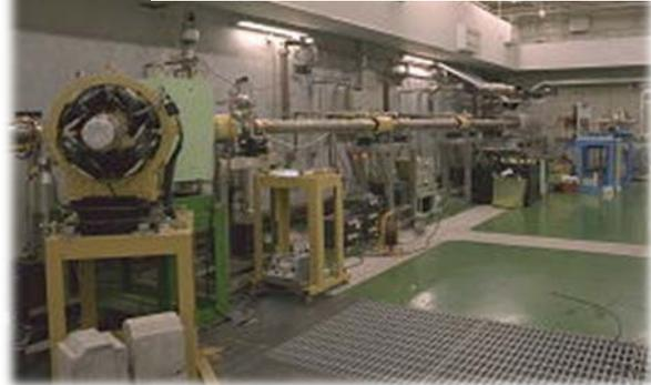
150 MeV Sバンド電子ライナック用い低速陽電子ビームを生成させます。陽電子寿命測定等、陽電子ビームを用いた材料評価研究に利用されます。
