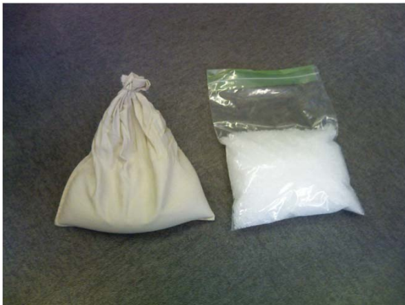
図6：貫通孔遮蔽に用いた鉛顆粒入り袋及びポリエチレンビーズ
