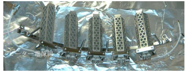
図3: NEGポンプユニット(400L/s x 5本)
