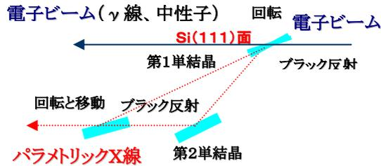
図1 パラメトリックX線放射実用化の基本構成
