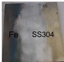
図8 鉄-ステンレス溶接片の写真
