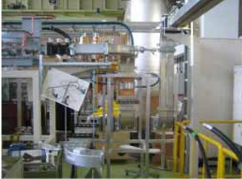
図1：2号機PDS（左上が5MWサーキュレータ、中央が切り替え部、右上が1号機側への導波管）
