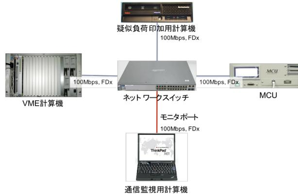
図 2: 脆弱性試験用ネットワーク。VME計算機、MCU以外に疑似負荷印加用計算機、通信監視用計算機を接続している。
