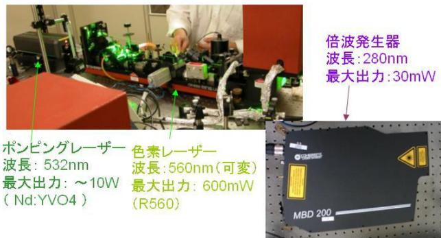
図2 : レーザーシステム
