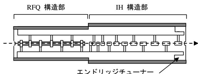
図1 複合加速単空洞リニアック内部構造の簡略図
