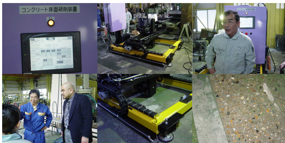
図2 床研削装置と研削されたコンクリート床面、骨材の石がみごとにカットされているのがわかる。
