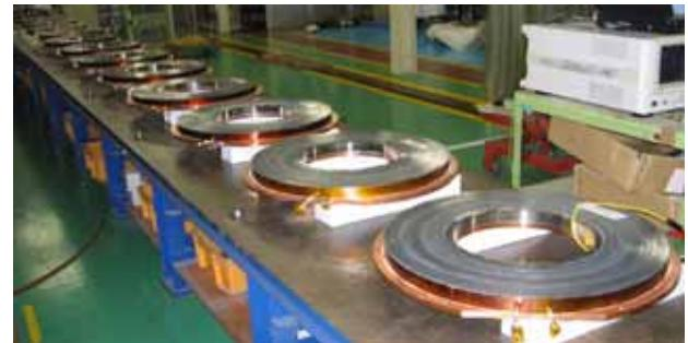
図 2 。冷却銅板に接着された Co 基アモルファスコア。
