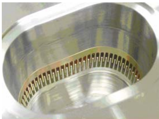
図1：レーストラック型断面(76x48)の櫛歯型RFシールド付ベローズチェンバーの内面
