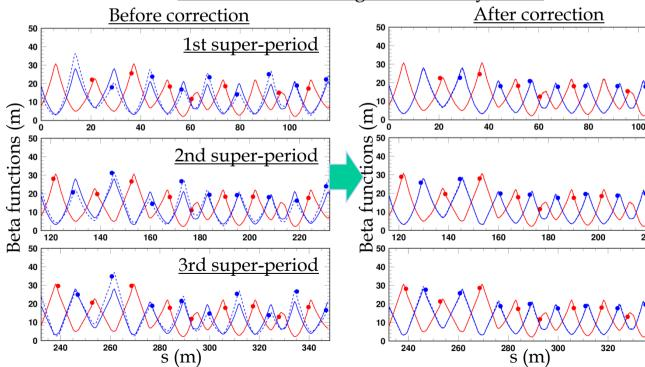
✓ エッジ収束により発生した y方向のベータ関数変調は、 新規導入した6台のQDTsで ✓ 上手く補正された
