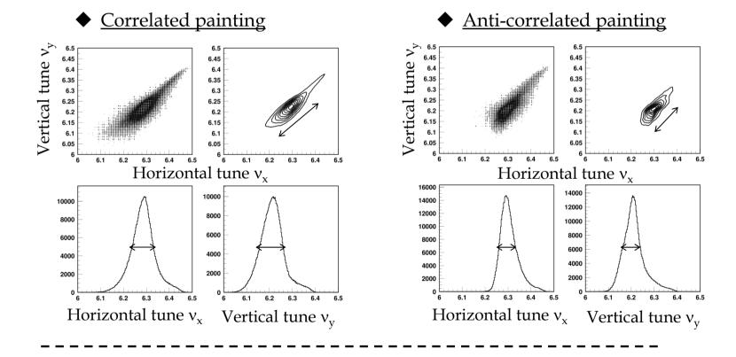
以上の考察を踏まえ、 $1 \, \text{MWビームを使って更なるペイント範囲の拡幅を試みた} 200\pi \, \text{mm mrad ペイントを試した}$
