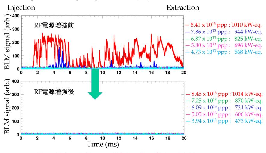
✓ RF電源の増強・FF調整により、縦方向のビーム損失は除去された
