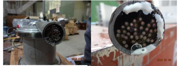
やはり管とエポキシの間で空気が漏れる。管とエポキシの間の隙間をシリコンを塗って気密試験を行うと、圧力を保持する。
