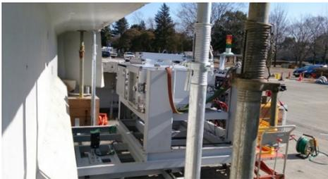
(b)可搬型 X バンドライナック 3.95MeV X 線源の設置。
