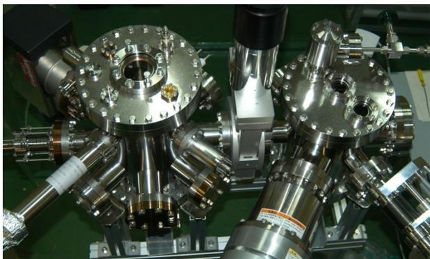
図7：GaAs光陰極導入・準備容器。名古屋大学の装置[7,8]を参考に設計。パック、タングステンヒーターは名古屋大装置のコピー。
