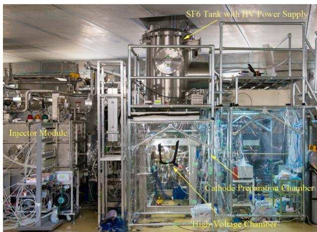
図9：cERLに移設した500kV光陰極直流電子銃。
