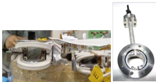
Figure 3: 拡張されたスリットの例。左図が入射磁気チャンネル、右図が入射ラインスリットである。
