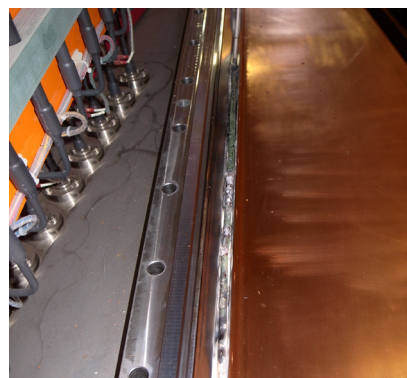
Figure 4: Burned-out C-ring in fRC-W resonator. 焦げた原因は接合面の締め付けが不十分であると考
