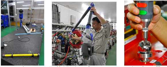
図5、左:LTXiと基準長、右:FAROARMの測定風景。
