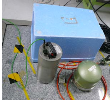
図9 カバーの効果を見るために1台は発泡スチロールで覆っている。
