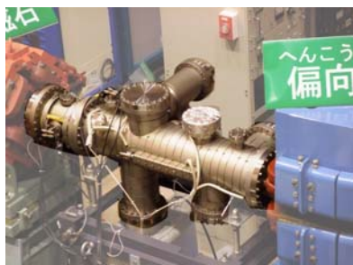
図4：UVSORブースターシンクロトロンのRFKOチャンバー
