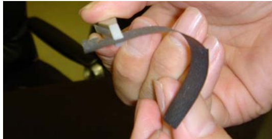
図2. カーボングラファイトのサンプル片。
