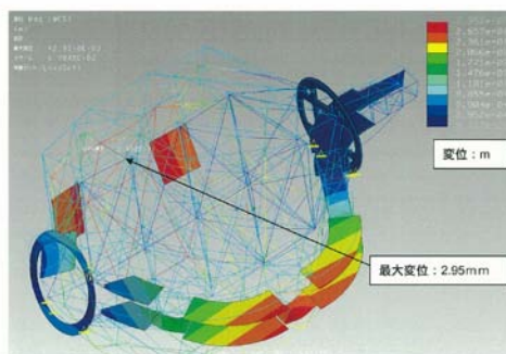
図7：炭素線回転ガントリー構造体の変形に関する計算結果。ガントリー回転角は90度。
