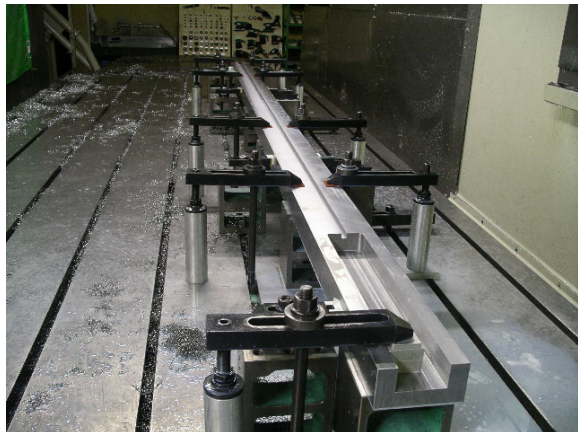
図3：第2コリメータ加工時の様子 (コミヤマエレクトロン社提供)
