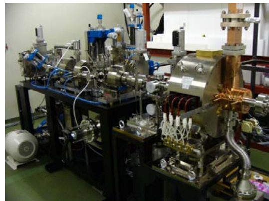
Fig.4 フォトカソードRF電子銃を利用した時間分解電子線回折システムとフェムト秒RF電子銃
