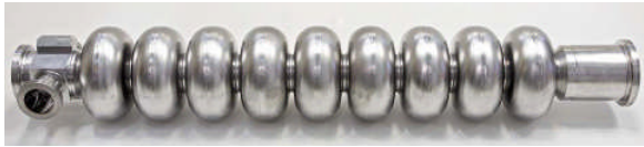
図3：主リニアック用超伝導加速空洞（9セル）
