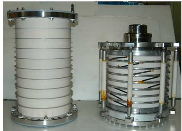
図1 : 500 kV-ERL 電子銃 (左) と 250 kV-JAEA-FEL 電子銃 (右) とともに分割型セラミック管
