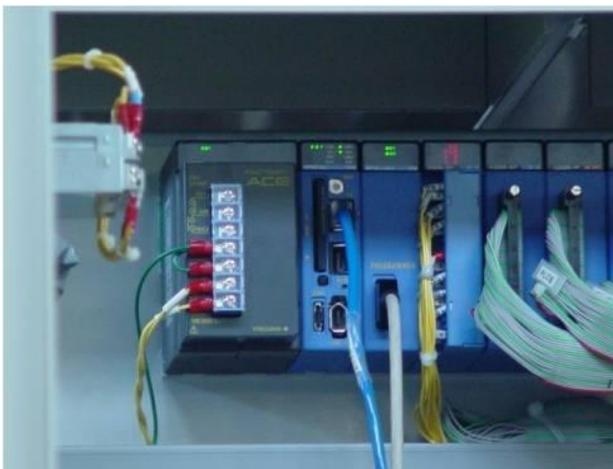
図2 : F3RP61 (左端の電源モジュール右隣)
