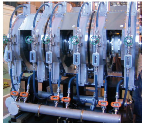
図1 J-PARC RCS用高周波空洞
