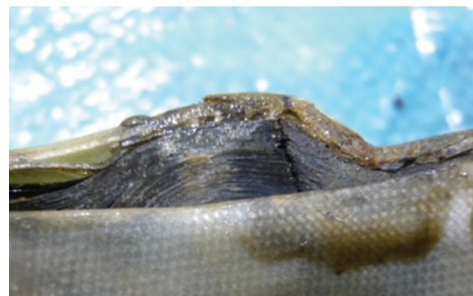
図5 座屈コアリボンの様子。座屈部分のリボンが断裂していた。
