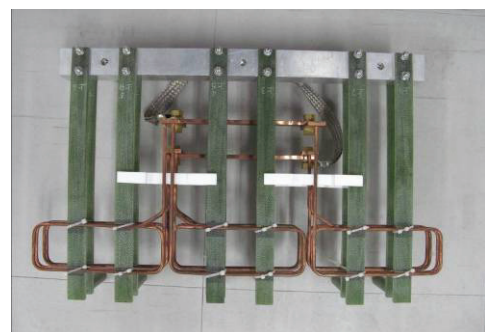
図3：新たに開発したビーム取出しキッカー電磁石
