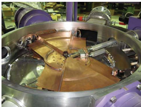
図1：入射サイクロトロン内部点検
