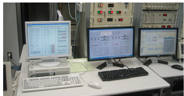
図5 リニアック制御計算機。ディスプレイ左より、電子銃個別制御、モジュレータ電源個別制御、入射連動制御。背後はマニュアル操作用既設制御盤。
