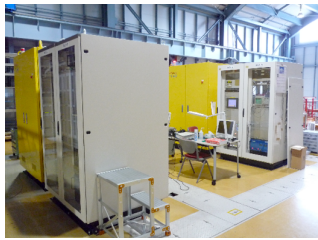
写真2. 第2電子銃モジュール (手前、奥は第1電子銃モジュール) と第1電子銃モジュール内部。
