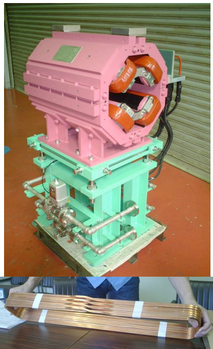
図2 RQ磁石の外観と転移型コイル
