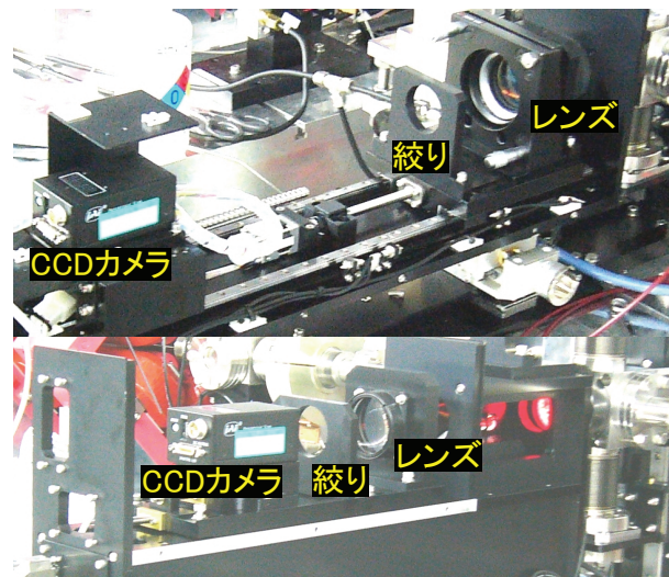
図 5: SCSS 試験加速器に設置されたスクリーンモニタ光学系(上:4倍光学系、下:0.44倍光学系)
