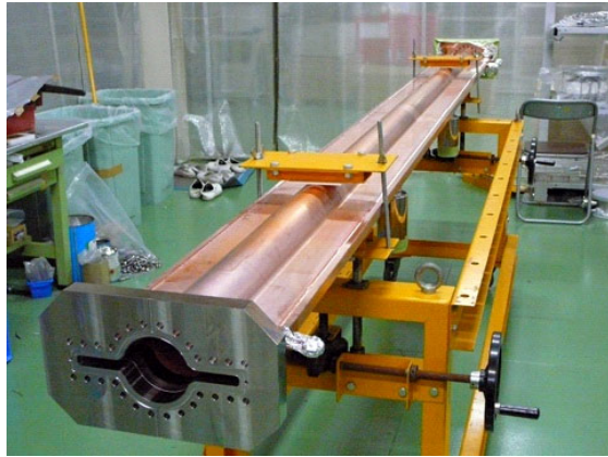
図1：ウィグラー部用ストレートダクト
