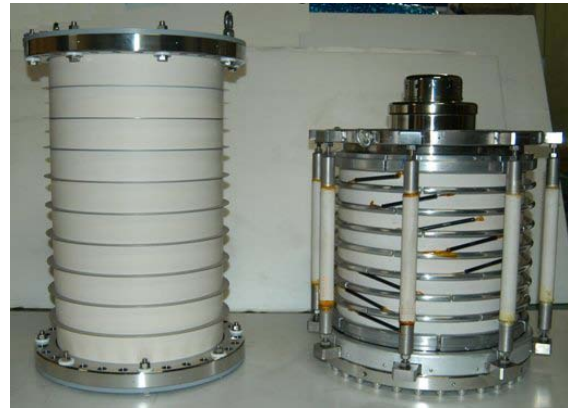
図2. JAEA高出力FEL熱電子銃用セラミック管(右側)および500kV光陰極DC電子銃用セラミック管(左側)の写真。熱電子銃用セラミック管については分割抵抗、サポートロッドが取り付けたまの状態である。
