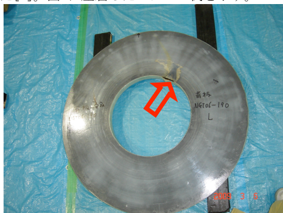
図1：座屈したコアの一例(赤矢印部)
