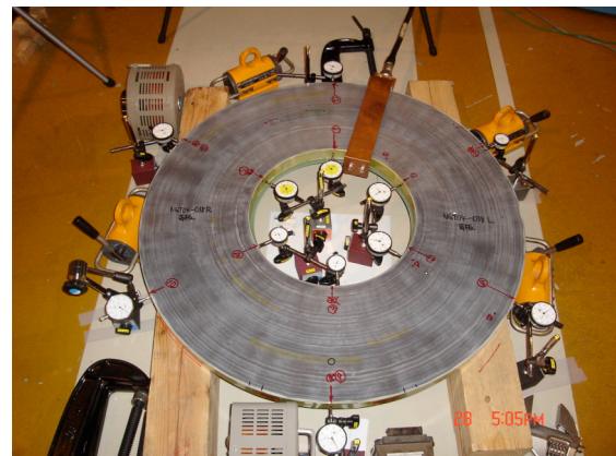
図2：コアの大気中加熱実験
