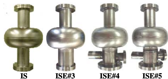
図1:ICHIRO型単セル空洞 IS: レギュラーセル形状、ISE: エンドセル形状
