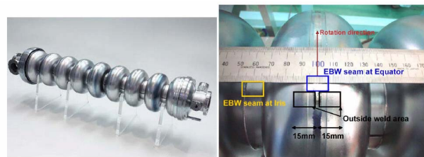
図1：STF Baseline空洞（MHI-Cavity）と観察箇所
