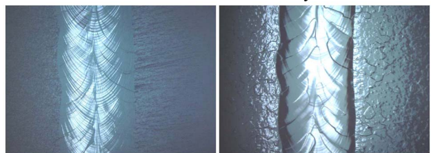
図2：空洞受取後（左）、EP-1後（右）における赤道部の表面状態（MHI-05）
