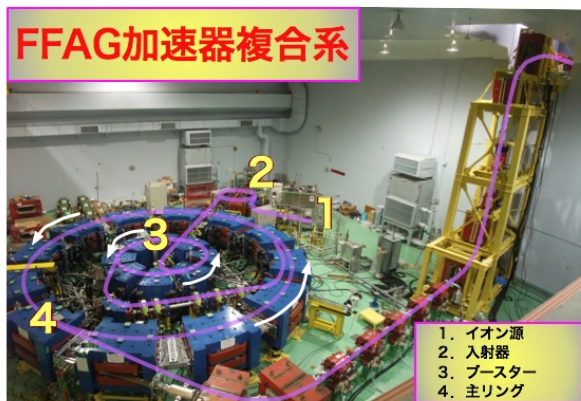
図 1:KURRI に建設された FFAG 加速器複合系
