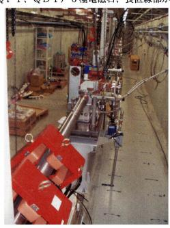
図2.6MeV入射器側から眺めた250MeV リニアックとエネル ギー分析用BT系 手前から第1加速管と4極電磁 石、6本の加速管が並ぶ
